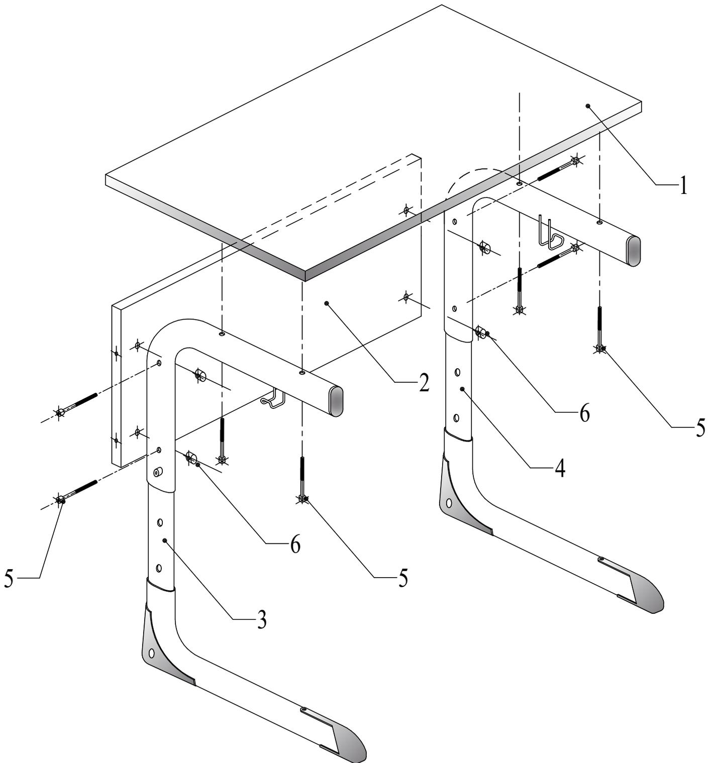
6.1. При помощи винтов (5) и гаек (6) соединить боковины (3 и 4) экраном (2).
